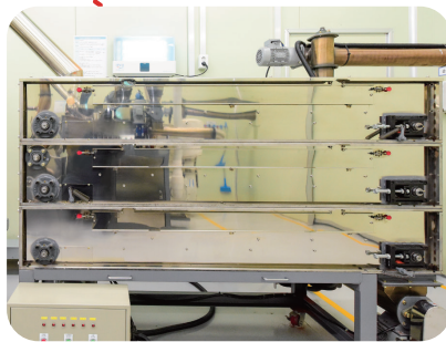
3단UV살균기 (CCP-2) 미생물,곰팡이균 등 자외선살균 공정 2시간 마다 측정기구를 통하여 모니터링
